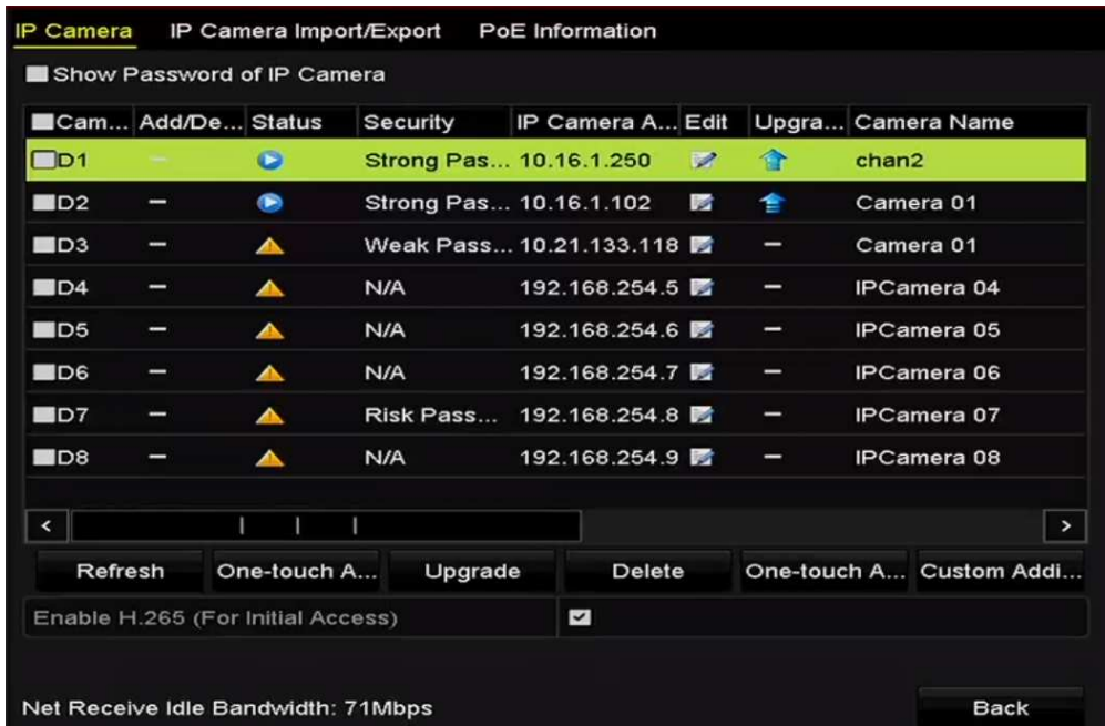
Figura 2–30 Interfaz de adición de cámara IP
