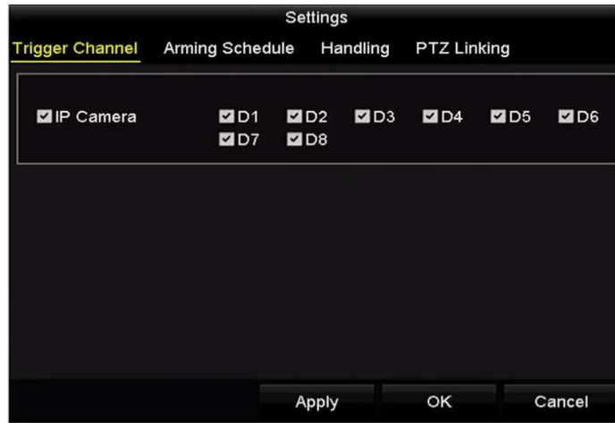
Figura 9–15 Establecer activación de cámaras de POS
