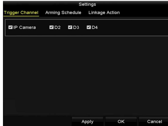
Figura 5–20 Establecer la cámara de activación de la alarma VCA
